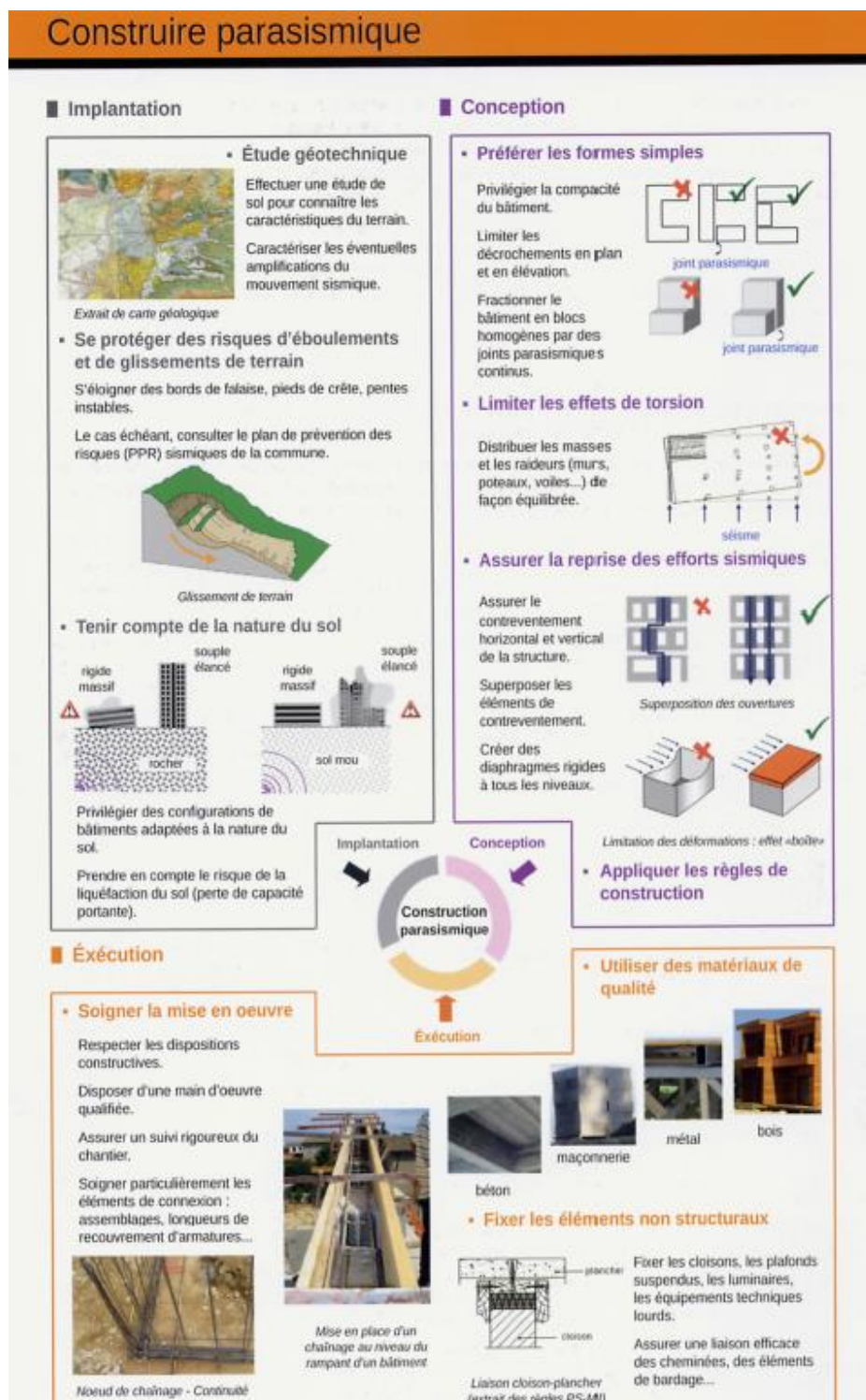
Figure 44. Grands principes de la construction parasismique
