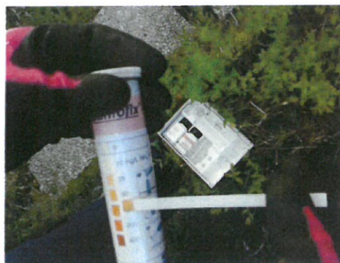
Résultat du test \text{NH}_4^+ 50mg/L
