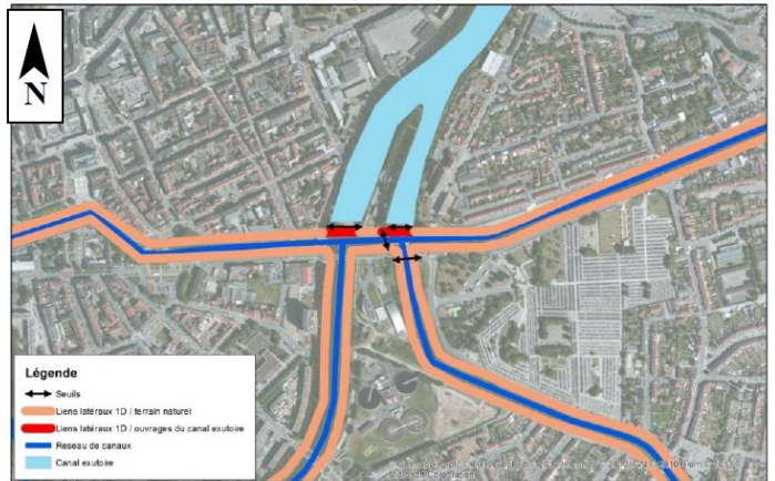
Illustration 55: Détail sur les modalités de couplage 1D/2D au niveau du site des 4 écluses (EDD Digue des alliés/barrage Tixier, 2017).
