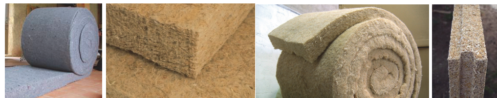
A FAIRE : isoler par l'intérieur en utilisant des matériaux perméables à l'eau (laine de chanvre, de bois, de coton, ouate de cellulose, ...)
