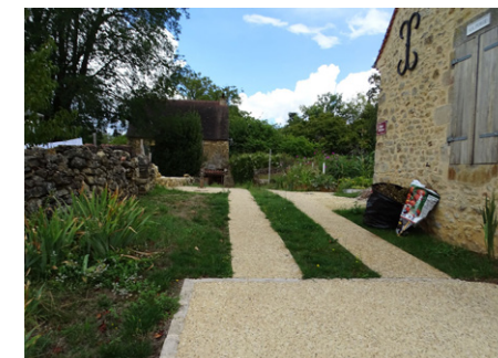
L'imperméabilisation du sol est limitée au maximum : simple emprise d'un cheminement piéton et sillon des roues des voitures (à gauche Coux et bigaroque - Mouzens, à droite Doissat)
