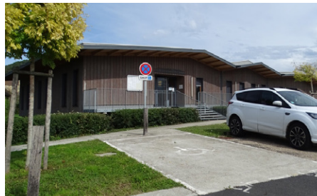
Exemples de stationnement perméable : ici, environ 70% de la surface est perméable (Saint-Cyprien)
