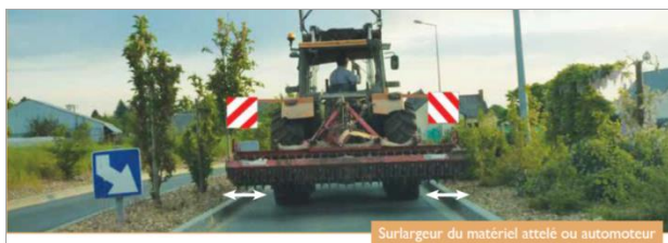
Les aménagements urbains peuvent pénaliser le passage d'engins agricoles de grande largeur
