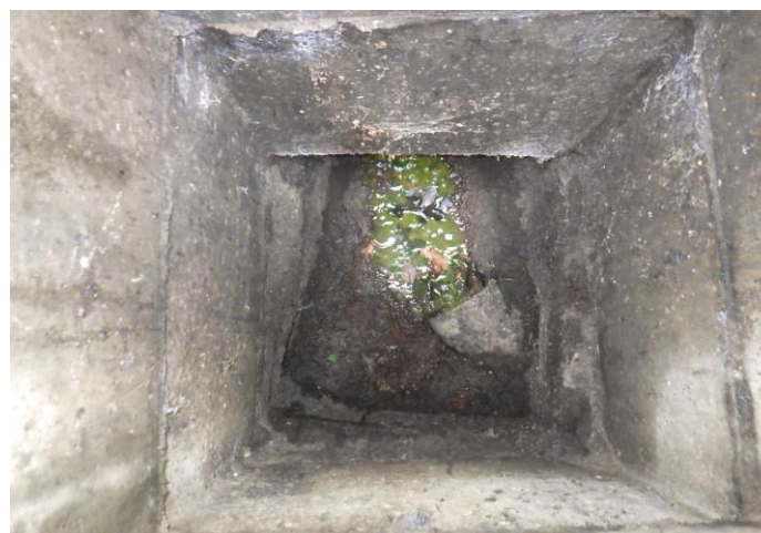
Colorant dans le regard des eaux usées
