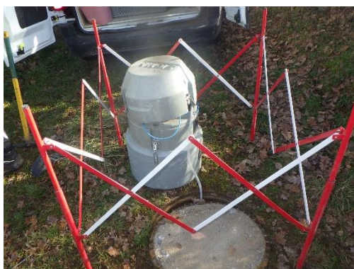
Point de prélèvement en entrée de la lagune des Traives
