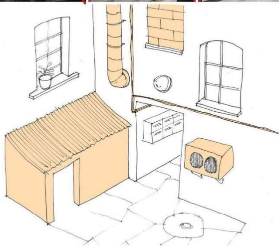
Quelques éléments devant être ciblés lors de travaux : gaines d'aération, installations électriques, appareils de climatisation... ces éléments doivent être intégrés. Les appendices «parasites» pourraient être démolis pour valoriser la cour.
