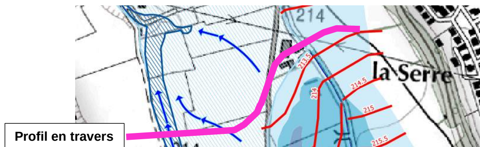
Fig. 54. Profil en travers du lit majeur de la Mielle à l'isocote 213.5
