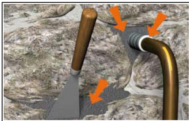
Situation après travaux de colmatage
