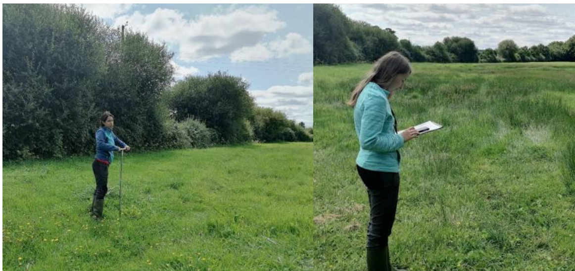
Figure 4: Prospection dans le cadre de la réalisation d'un inventaire de zone humide communal : sondage pédologique, caractérisation et usage de la saisie sur tablette (DCI Environnement)
