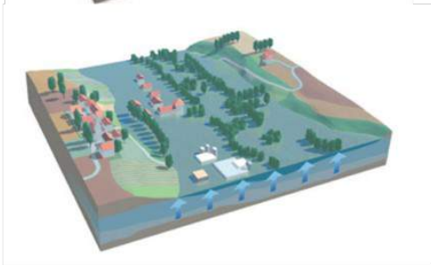
Remontée de nappe
