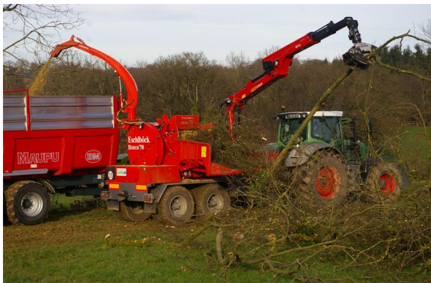
Figure 15. – Déchiquetage de bois de haie avec le matériel CUMA
