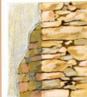
mur ancien souvent maçonné à la terre, enduit fin à la chaux (intérieur et extérieur)
