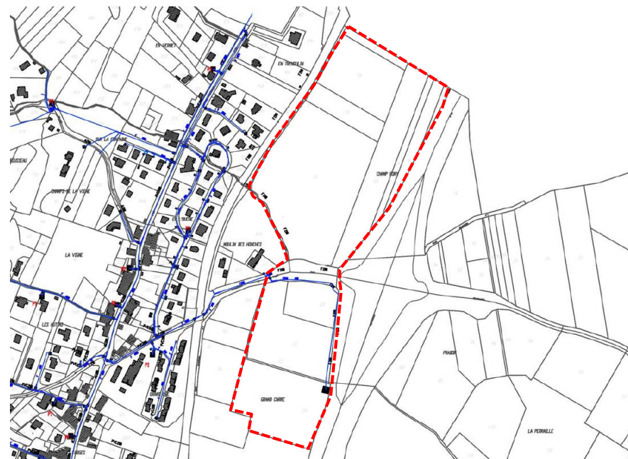
Réseau des eaux usées au droit du site d'étude
