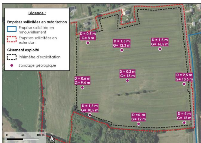
Sondages géologiques réalisés sur la zone d'extension à Saint-Loup-du-Gast (source : Pigeon Carrières)
