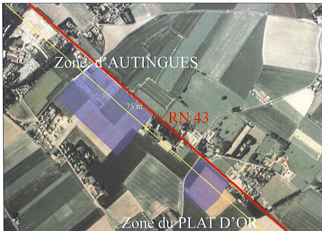
Figure 1 : La proximité immédiate de la route nationale 43 (reliant Calais à Saint-Omer) nécessite la réalisation du présent dossier afin de justifier un aménagement dans la bande des 75 mètres définie par la « loi Barnier ».
