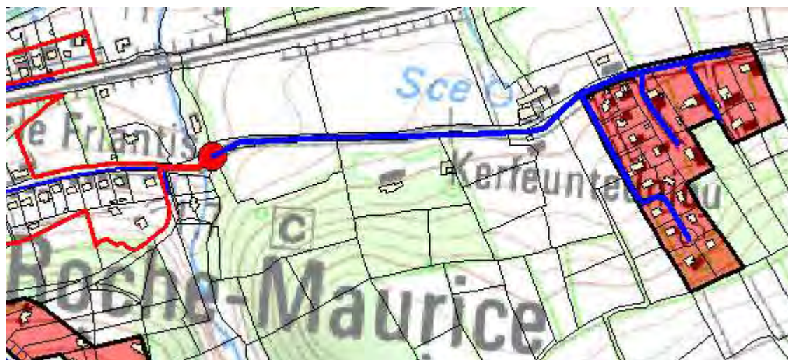
Figure 66 : Scénario 2 : Création d'un assainissement collectif
