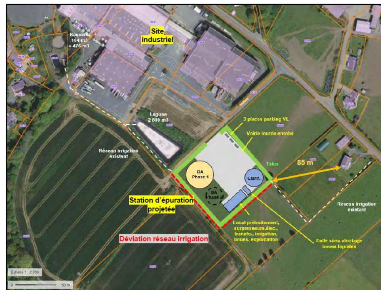
Figure 6 : Emplacement de la station d'épuration en projet
