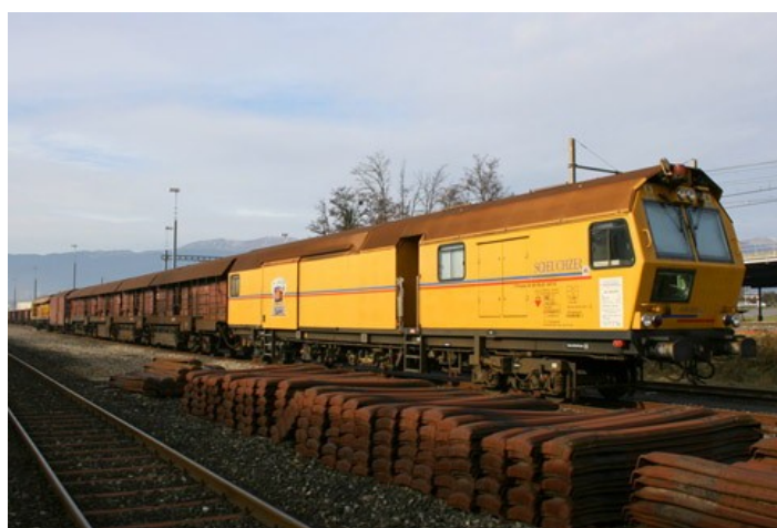
Train meuleur de rails (Scheuchzer S.A.)
