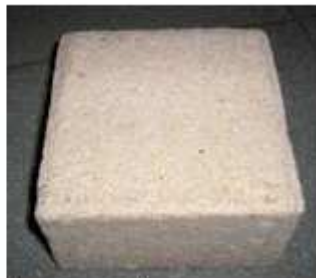
Pavés en béton poreux
