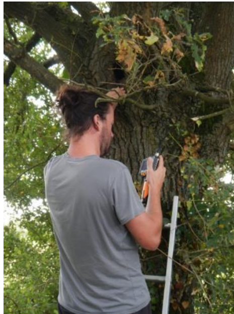
Figure 4 : Examen d'une cavité à l'aide d'un endoscope
