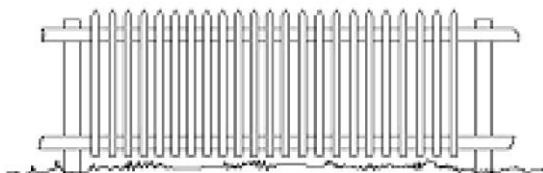
Clôture type de montagne (palisson).
