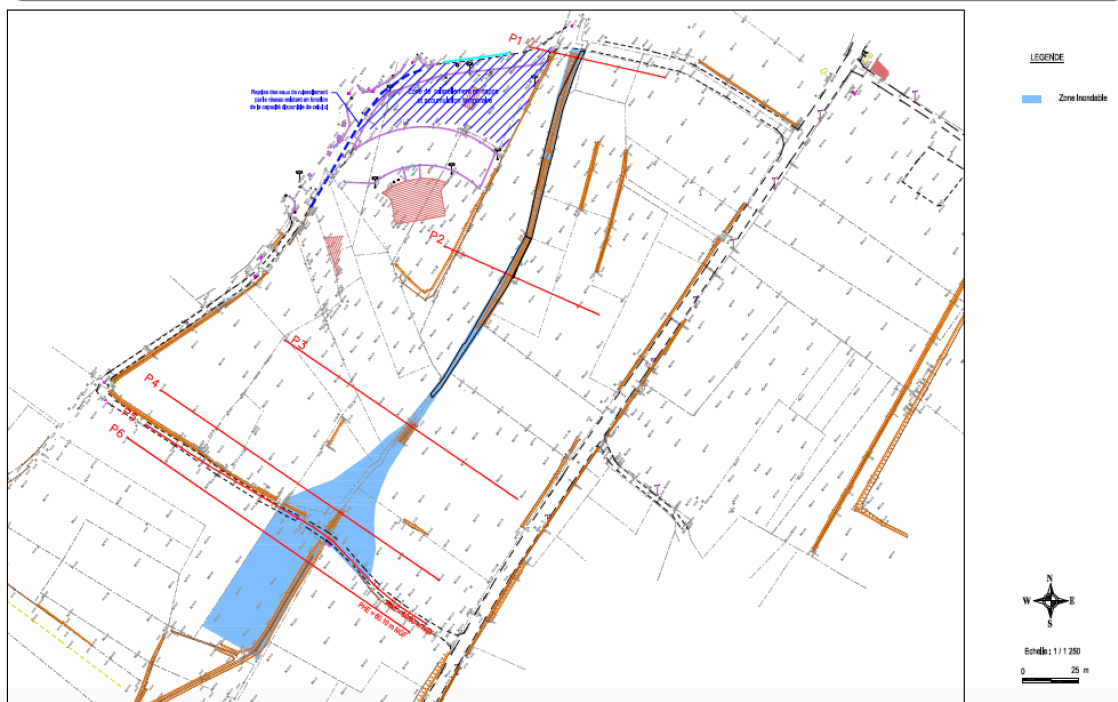
Emprise de la zone inondable du ruisseau des Gamenteilles pour le débit décennal
