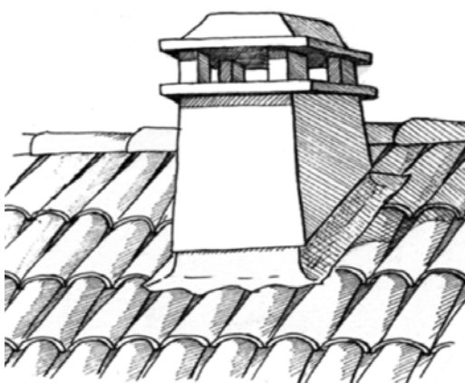
Souche de cheminée avec "chapeau" sur plots de brique ou de petits moellons taillés
