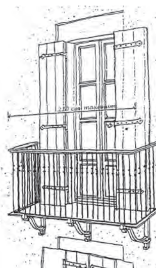
Balcon métallique (extension du XIXe siècle)
