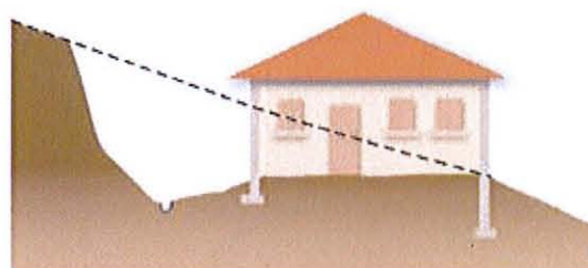
Plate-forme en déblais
