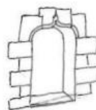
Linteau en accolade
