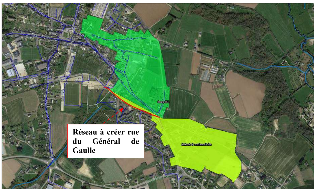
Figure 81 : Scénario 5 - Surface de l'impluvium déviée
