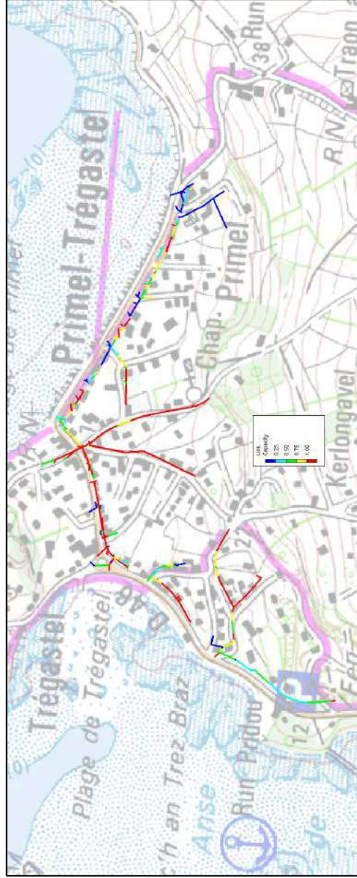
Figure 60 : Capacité des conduites lors d'une marée haute et d'une pluie quinquennale
