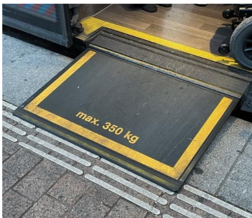
Figure 2 : Une rampe d'accès PMR (AURCA, 2024).
