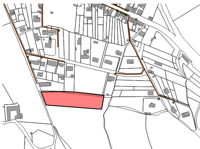
Réseau d'assainissement unitaire
