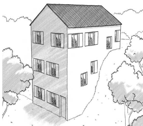
Illustration d'une hauteur identique à l'égout mais différente selon les côtés en raison de la pente
