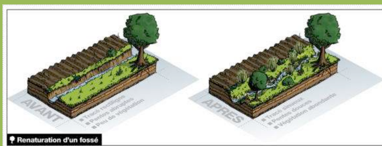
Schéma présentant la renaturation d'un fossé
