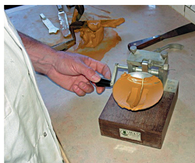
Figure 9 Détermination de la limite de plasticité au cône (à gauche) et à la coupelle de Casagrande (à droite) (Source Cerema)
