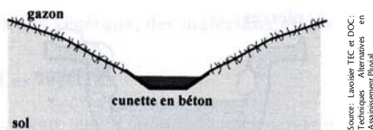
Fig. 3: Fossé engazonné muni d'une cunette en béton
