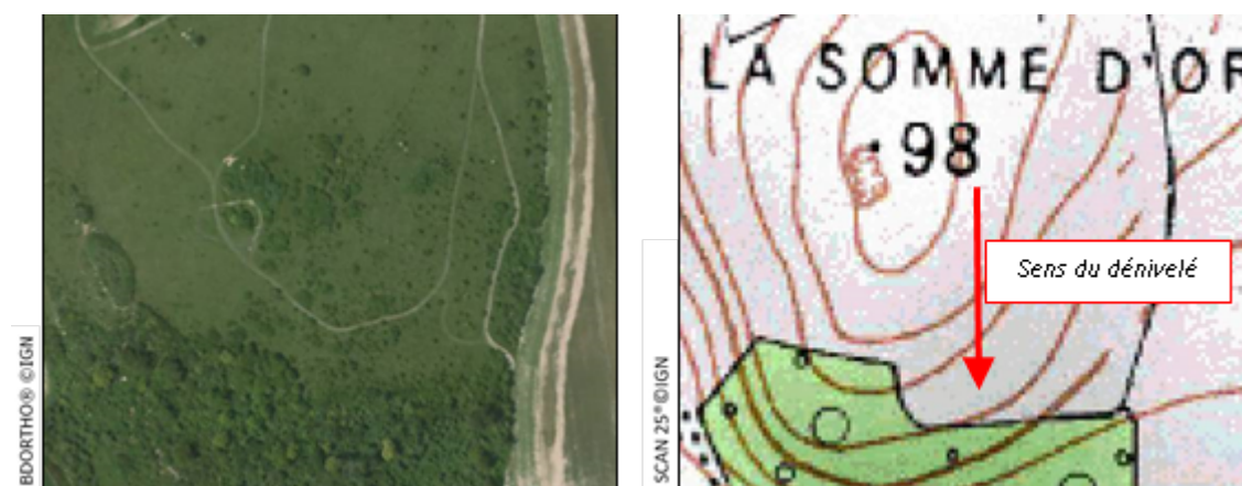
Figure 22 : Terrain à forte déclivité présentant une texture pouvant induire en erreur lors de la photo-interprétation
