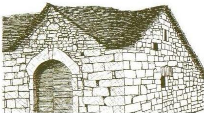
Noue arrondie et exemple de traitement de la rive en pignon.
