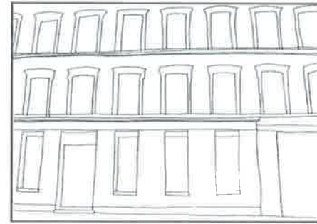
Baies avec tableaux axés sur l'étage
