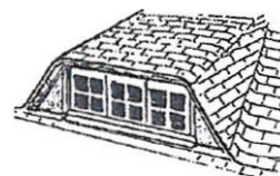
Lucarne en trapèze (couverture en bardeaux d'asphalte) ou lucarne à louée biaise
