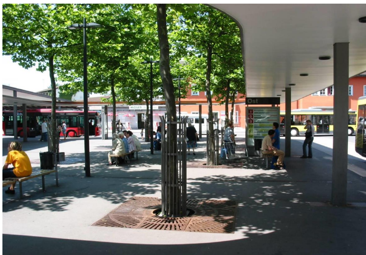
Figure 3 – Pôle d'échanges bus de la gare de Dornbirn (Autriche) qui fonctionne comme une petite place sur les bords de laquelle les bus accostent. Ce type d'aménagement est beaucoup plus convivial et plus compact que les gares routières en peigne
