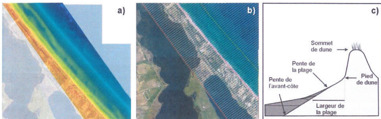
Illustration 5 – Utilisation du levé Lidar pour le calcul des variables morphologiques : a) extrait du modèle numérique de terrain ; b) discrétisation du littoral tous les 50 m et ; c) variables morphologiques utilisées (Balouin et al. , 2011).
