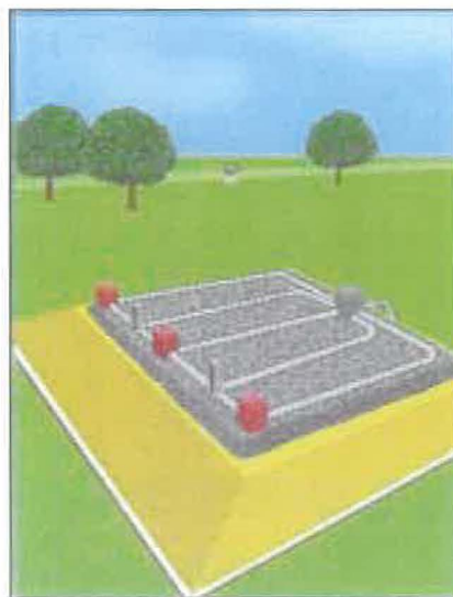
(Tertre d'infiltration non drainé (source CSTB))
