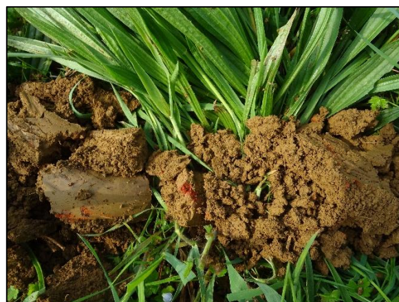
Figure 11 : Sondages 13 et 14, avec présence de rouille sur le sondage 14
