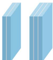
Vitrage simple feuilleté Nomenclature : XX.Y ou XXX.Y X = épaisseur des couches de verre (mm) y = nombre de couches d'isolant
