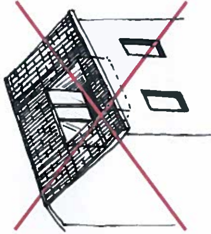
Terrasse de type « tropézienne »
