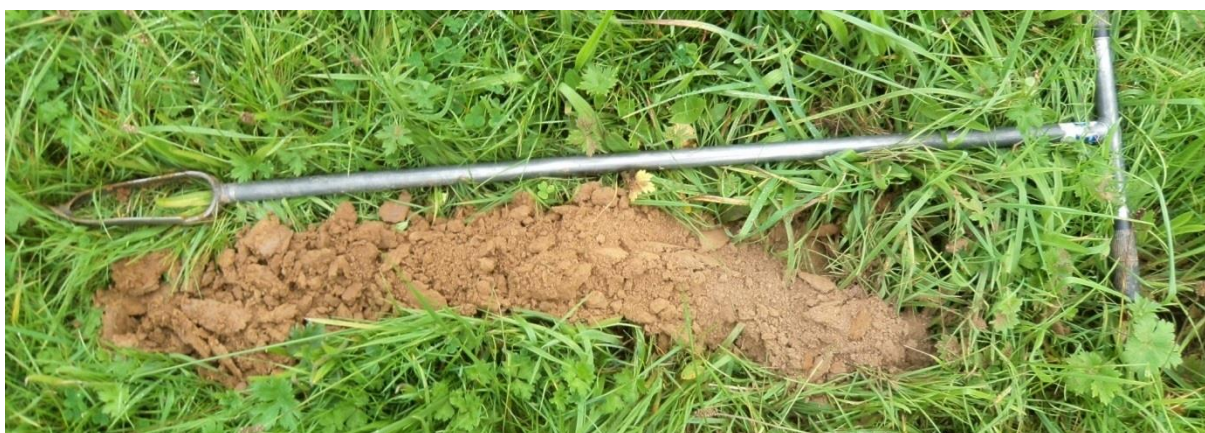
Sondage S6 montrant un limon profond, et de couleur homogène : sol sain, sans trace d'hydromorphie
