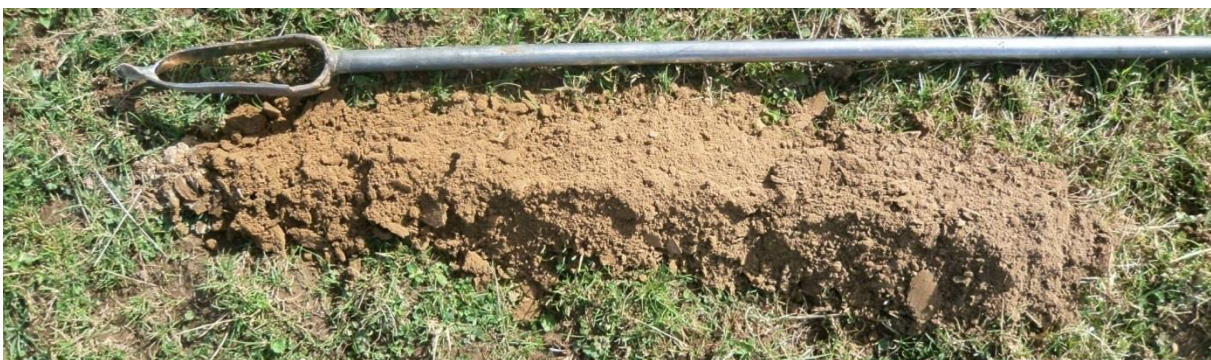
Sondage S133 montrant un limon profond et de couleur homogène : sol sain, sans trace d'hydromorphie
