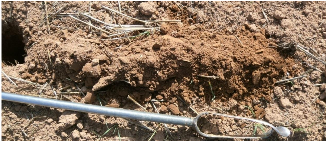
Sondage S46 montrant un limon moyennement profond, un peu caillouteux, et de couleur homogène : sol sain, sans trace d'hydromorphie
