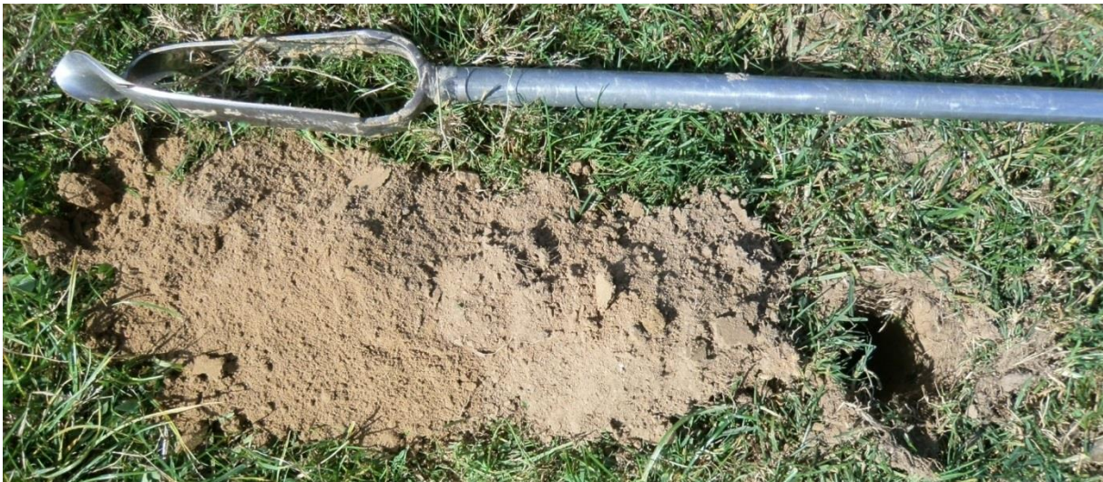
Sondage S40 montrant un limon moyennement profond et de couleur homogène : sol sain, sans trace d'hydromorphie
