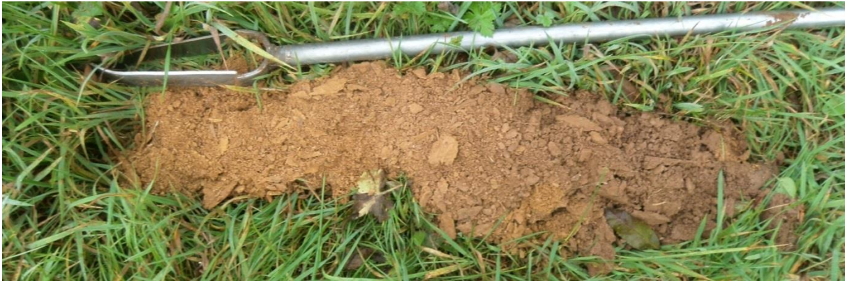
Sondage S149 montrant un limon profond, avec quelques traces d'hydromorphie apparaissant en profondeur
