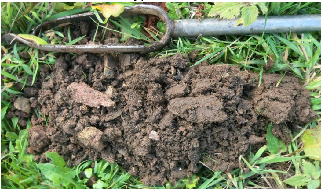
Sondage S162 montrant un limon sableux peu profond, montrant une petite passe argileux rougeâtre en fond de tarière
