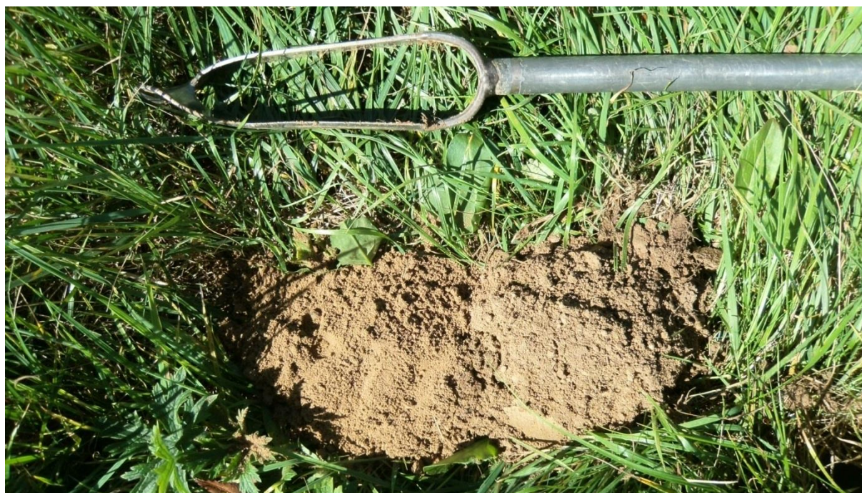
Sondage S89 montrant un limon peu profond et de couleur homogène : sol sain, sans trace d'hydromorphie
