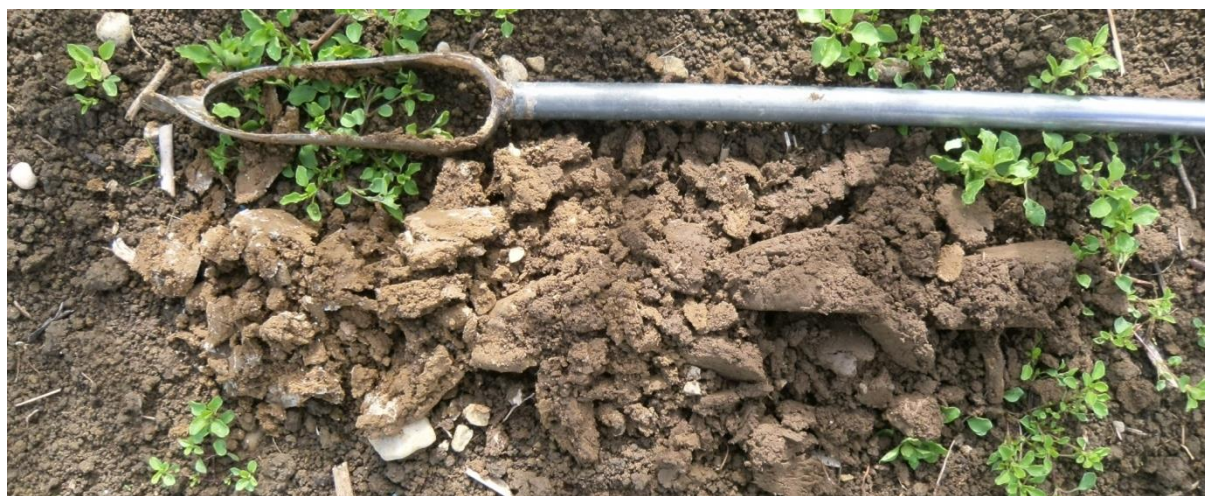
Sondage S209 montrant un limon moyennement profond et de couleur homogène, avec des cailloux calcaires apparaissant en profondeur : sol sain, sans trace d'hydromorphie
