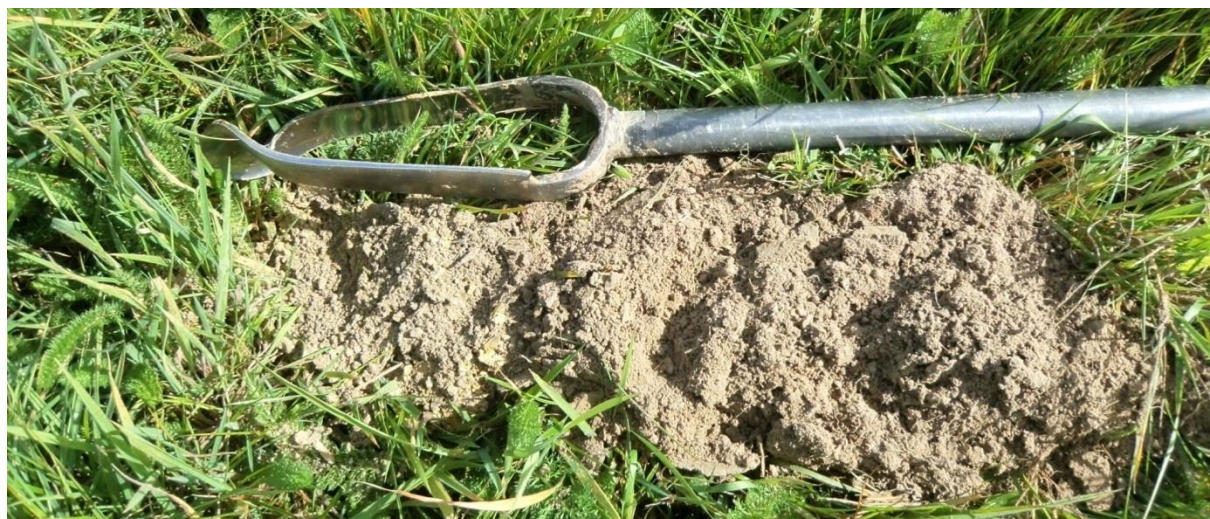
Sondage S71 montrant un limon peu profond et de couleur homogène : sol sain, sans trace d'hydromorphie
