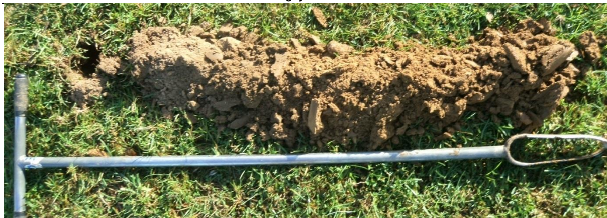
Sondage S13 montrant un limon profond et de couleur homogène : sol sain, sans trace d'hydromorphie
