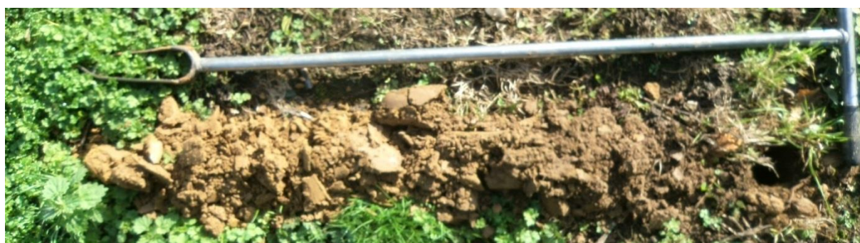
Sondage S13 montrant un limon profond et de couleur homogène : sol sain, sans trace d'hydromorphie
