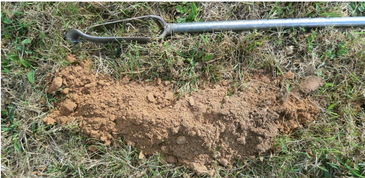
Sondage S77 montrant un limon moyennement profond et de couleur homogène : sol sain, sans trace d'hydromorphie
