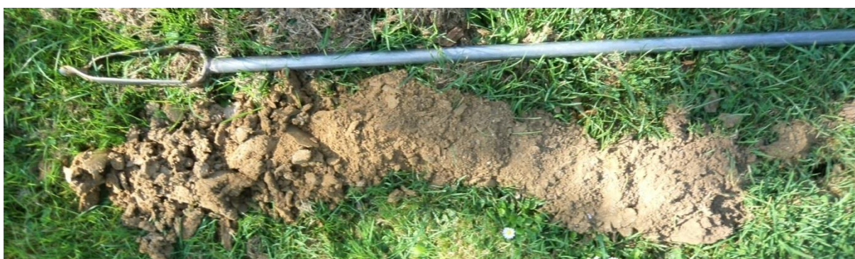
Sondage S116 montrant un limon profond, de couleur homogène, avec des tâches ocre apparaissant à partir de 70 cm de profondeur
