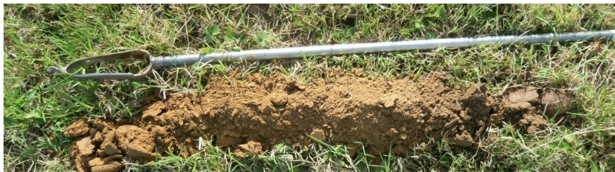
Sondage S140 montrant un limon profond et de couleur homogène
