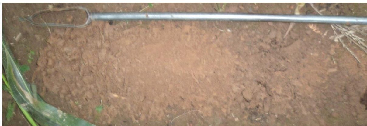
Sondage S96 montrant un limon profond et de couleur homogène : sol sain, sans trace d'hydromorphie
