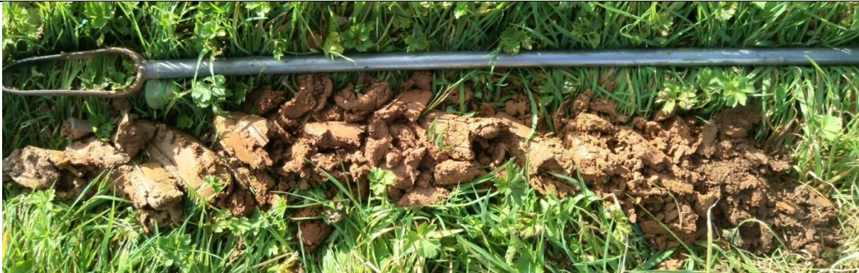
Sondage S174 montrant un limon profond, de couleur marron un peu grisâtre, avec des traces d'hydromorphie s'accroissant avec la profondeur
