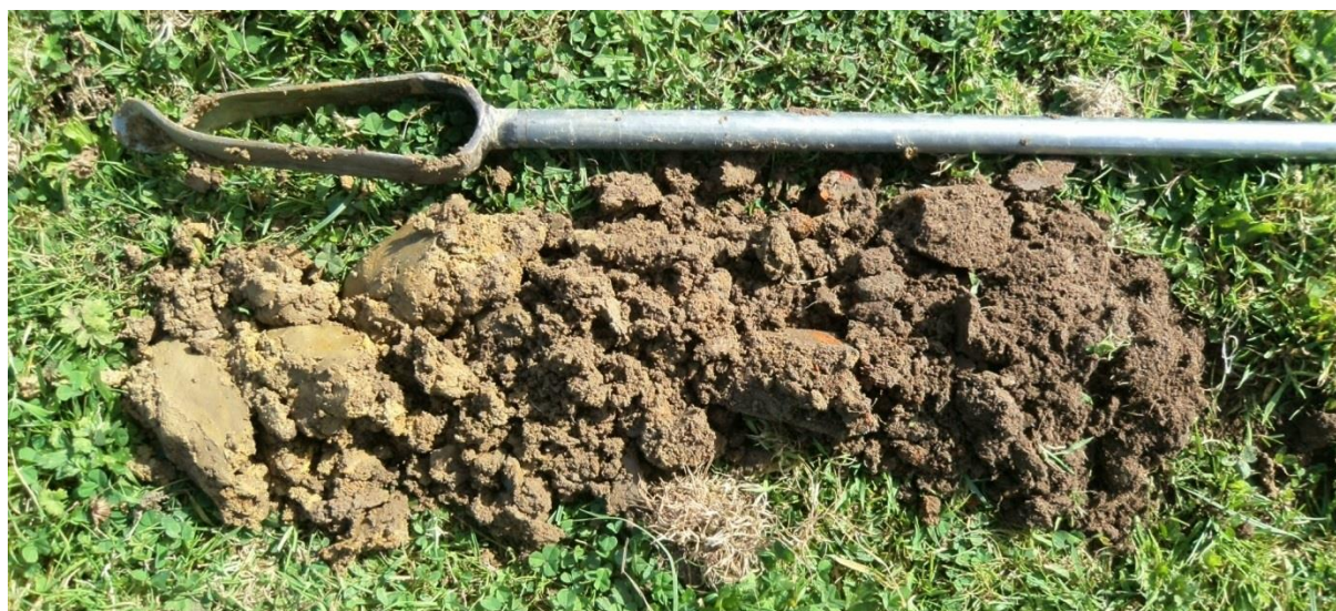
Sondage S35 montrant un limon sablo-caillouteux, frais à humide en profondeur, avec des traces d'hydromorphie. Il caractérise une zone humide.
