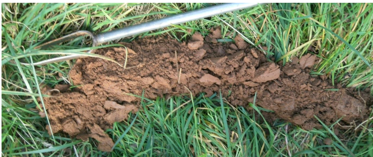
Sondage S164 montrant un limon profond et de couleur homogène, un peu rougeâtre : sol sain, sans trace d'hydromorphie
