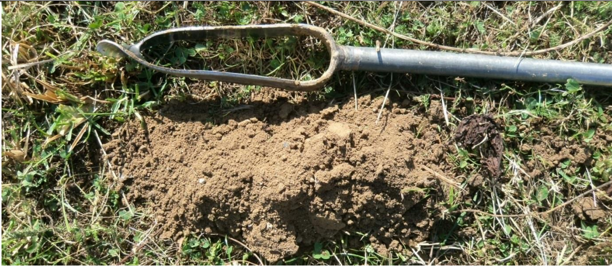
Sondage S110 montrant un limon peu profond et de couleur homogène : sol sain, sans trace d'hydromorphie
