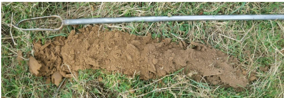
Sondage S181 montrant un limon profond et de couleur homogène : sol sain, sans trace d'hydromorphie
