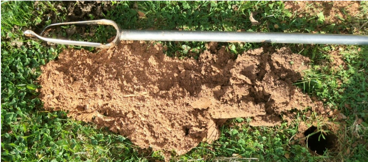
Sondage S165 montrant un limon moyennement profond de couleur homogène : sol sain, sans trace d'hydromorphie
