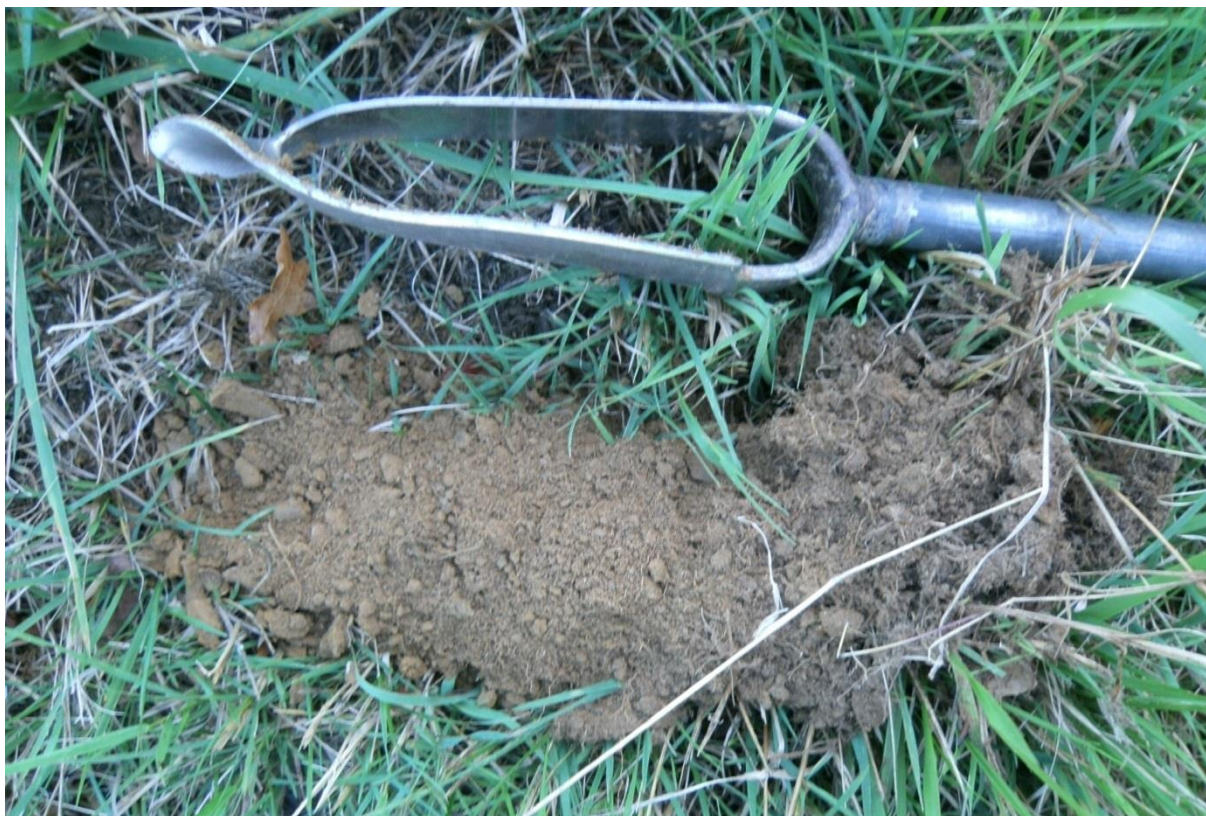
Sondage S85 montrant un limon peu profond et de couleur homogène : sol sain, sans trace d'hydromorphie
