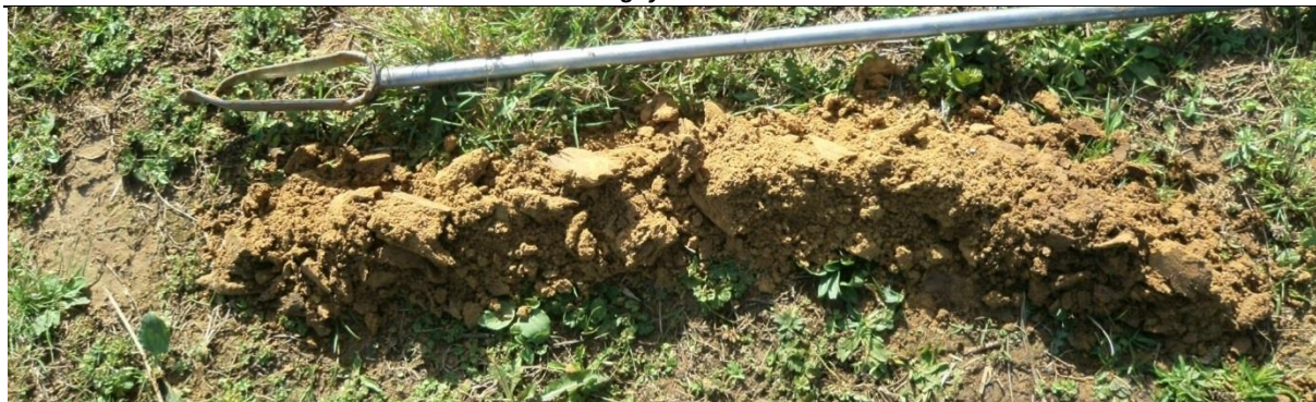
Sondage S130 montrant un limon profond et de couleur homogène correspondant à un remblais, reposant sur un niveau plus argileux, grisâtre
