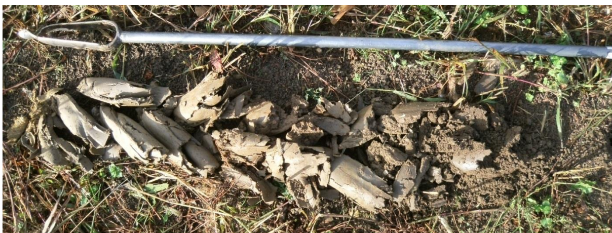
Sondage S98 montrant un sol de texture argilo-limoneuse, profond, avec la présence de tâches ocre à rouges : sol hydromorphe
