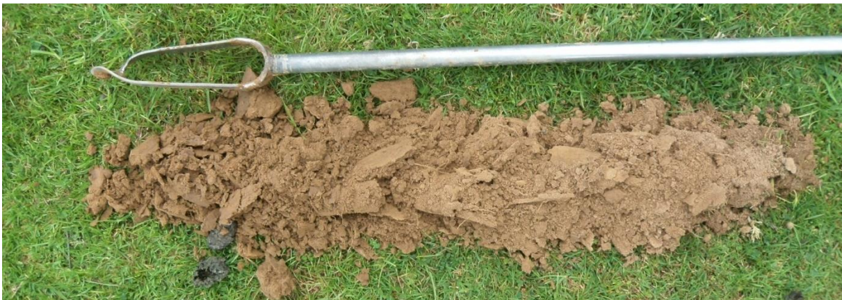
Sondage S212 montrant un limon moyennement profond et de couleur homogène : sol sain, sans trace d'hydromorphie
