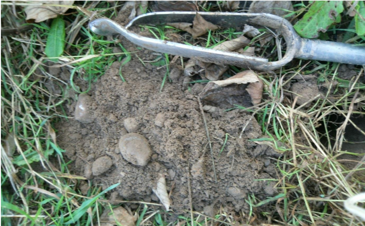
Sondage S13 montrant un limon profond et de couleur homogène : sol sain, sans trace d'hydromorphie
