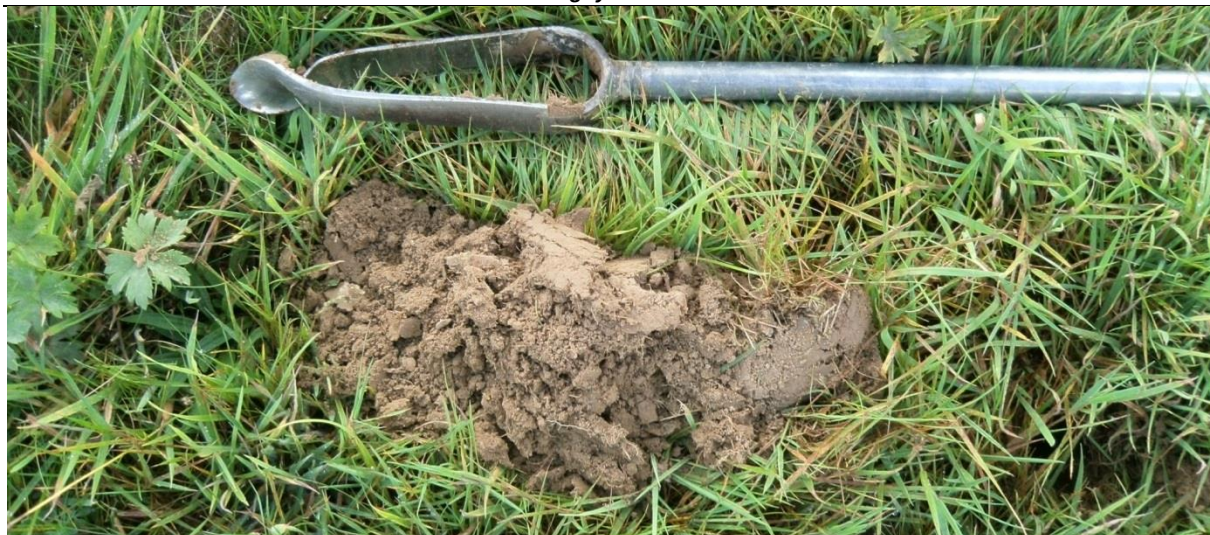
Sondage S60 montrant un limon peu profond et de couleur homogène : sol sain, sans trace d'hydromorphie
