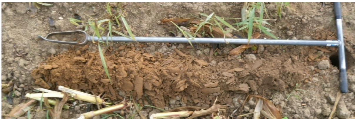
Sondage S98 montrant un limon profond et de couleur homogène : sol sain, sans trace d'hydromorphie
