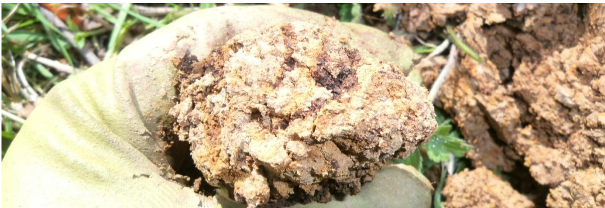
Sondage S151 montrant des traces d'hydromorphie marquées à partir de 50 cm de profondeur : bariolage gris/beige / ocre et concrétions noires
