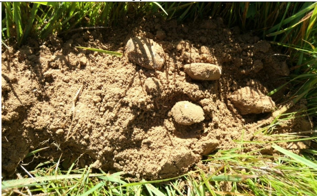
Sondage S78 montrant la présence de galets (refus sur niveau de galets, probablement du niveau géologique du Trias)
