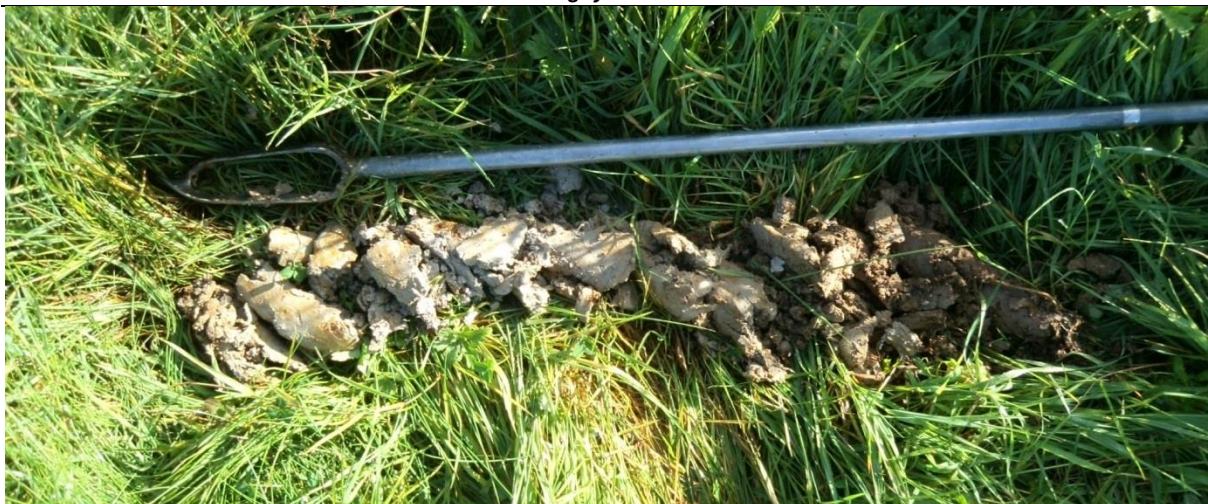
Sondage S52 montrant un limon profond, avec des traces d'hydromorphie s'accroissant en profondeur, et notamment la présence d'une couleur bariolée en fond de sondage
