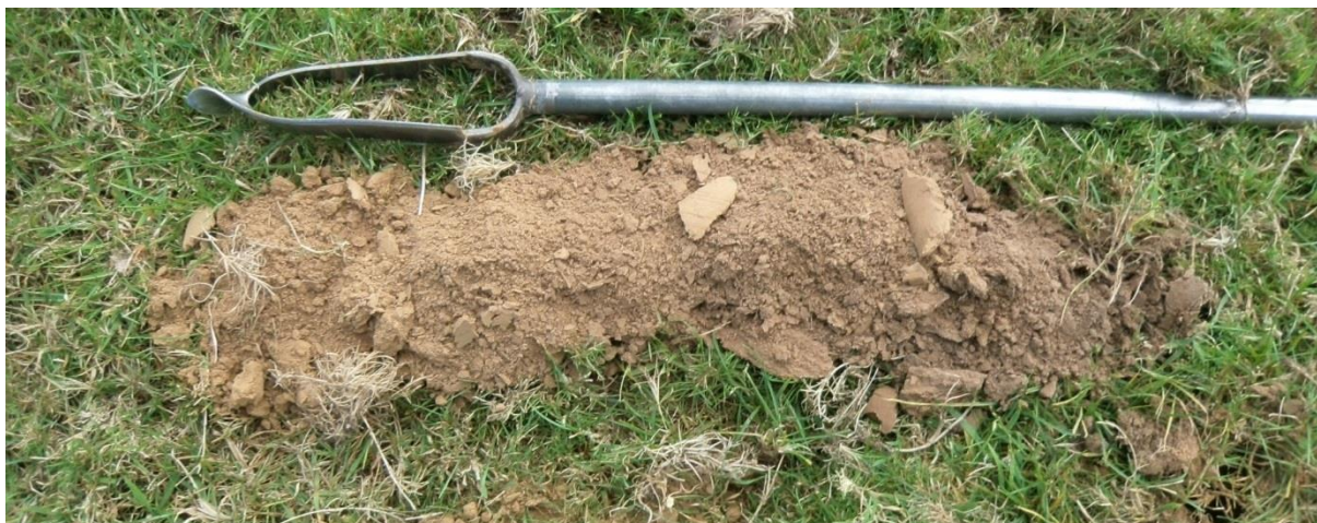
Sondage S21 montrant un limon moyennement profond de couleur homogène : sol sain, sans trace d'hydromorphie
