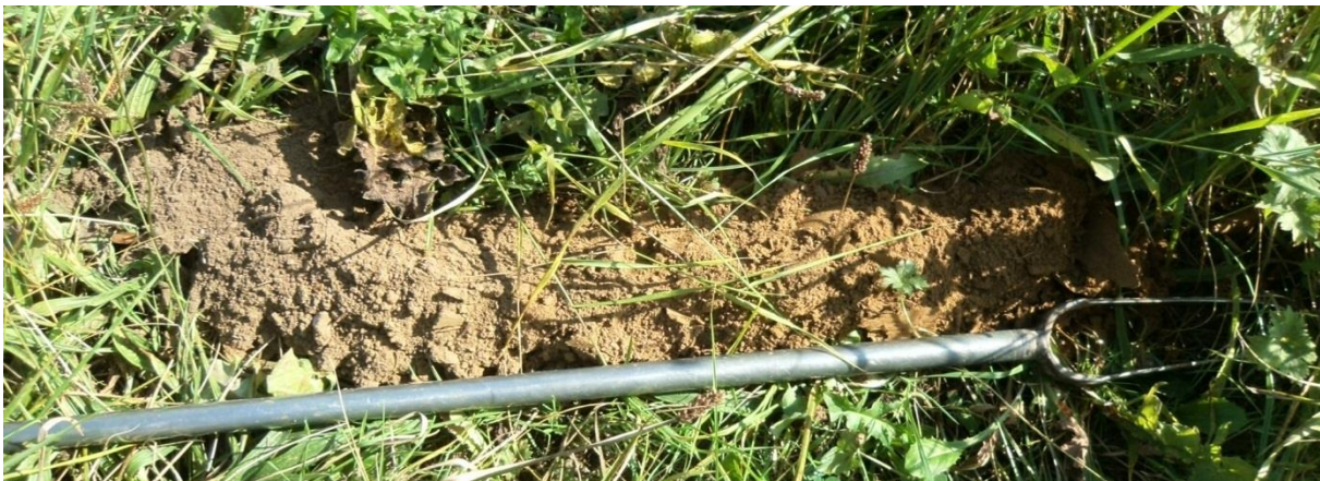
Sondage S115 montrant un limon profond et de couleur homogène : sol sain, sans trace d'hydromorphie
