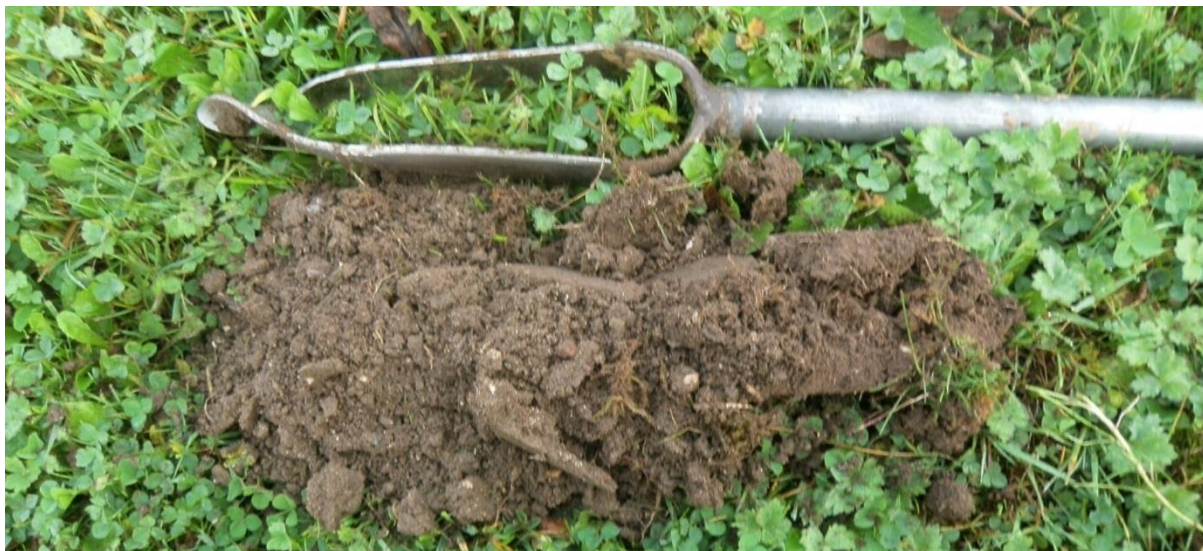
Sondage S145 montrant un limon sableux peu profond avec quelques cailloux.
