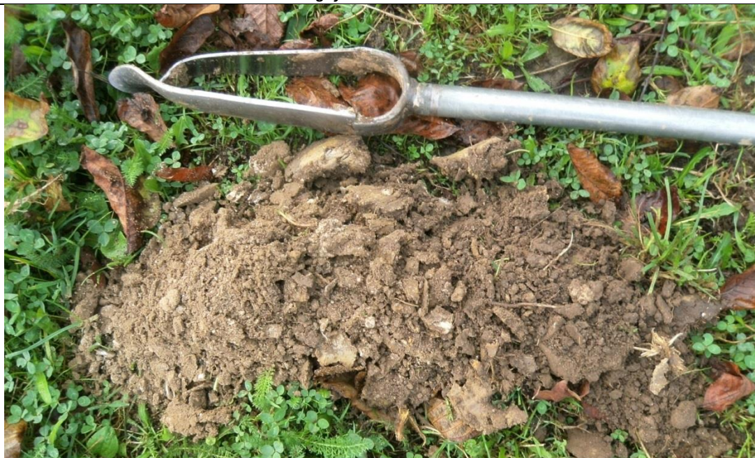
Sondage S144 montrant un limon peu profond caillouteux. Il pourrait s'agir d'un sol remanié
