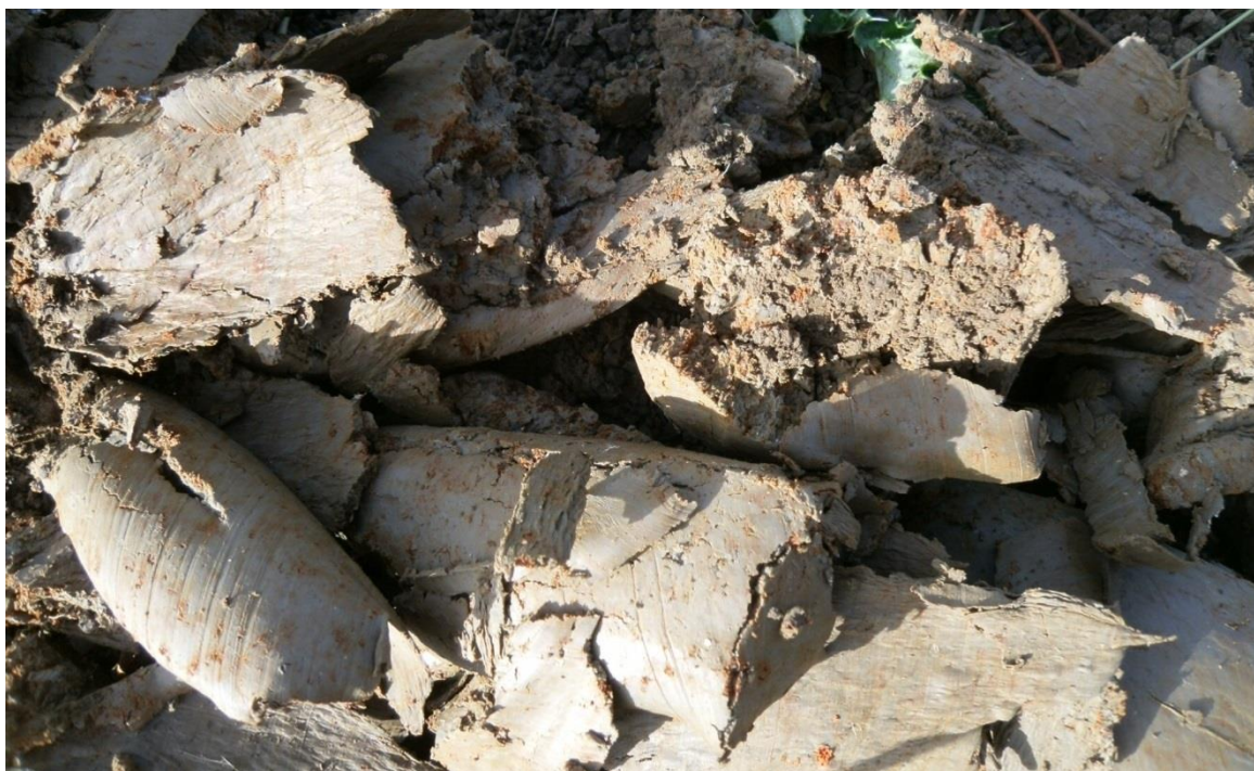
Sondage S98 : argile limoneuse en fond de coupe, avec des traces ocre à rouges (horizon réductique)
