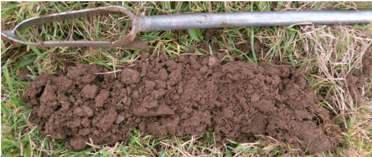
Sondage S205 montrant un limon sableux caillouteux (présence de galets de la Formation du Trias) peu profond, marron foncé, sans traces d'hydromorphie
