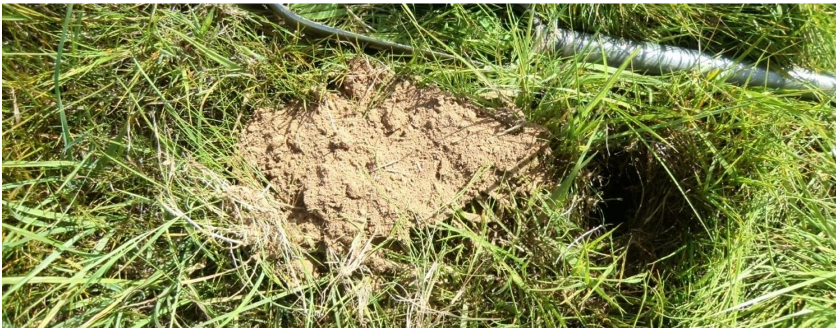
Sondage S13 montrant un limon peu profond et de couleur homogène : sol sain, sans trace d'hydromorphie
