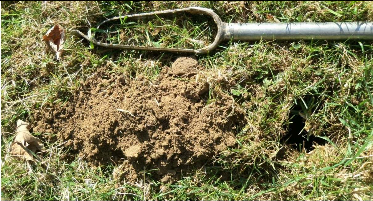
Sondage S119 montrant un limon peu profond et de couleur homogène : sol sain, sans trace d'hydromorphie
