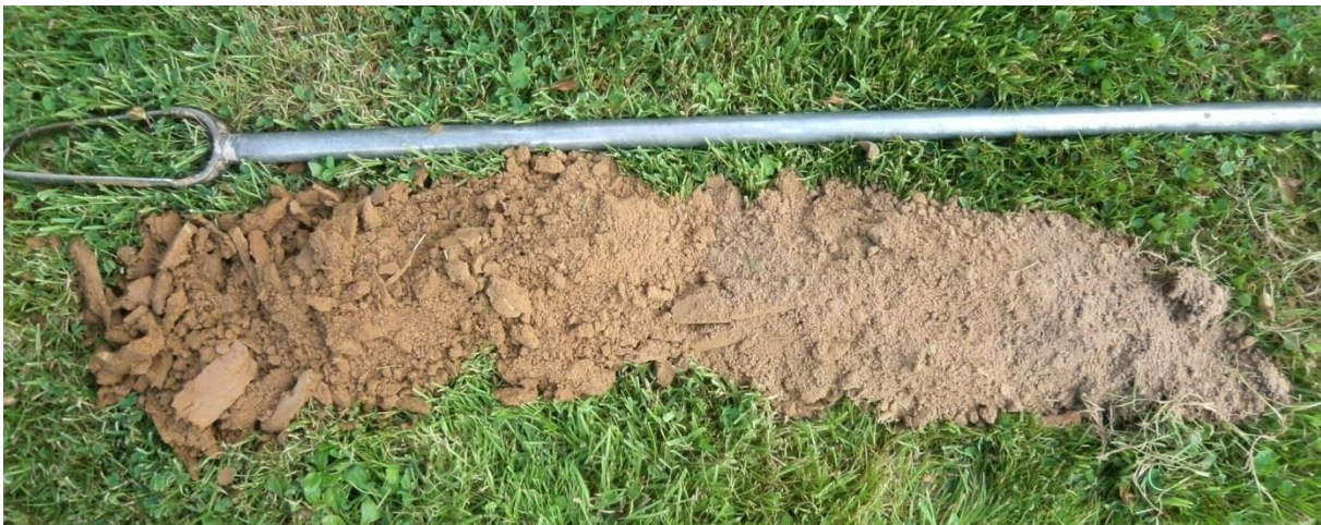
Sondage S19 montrant un limon profond et de couleur homogène : sol sain, sans trace d'hydromorphie
