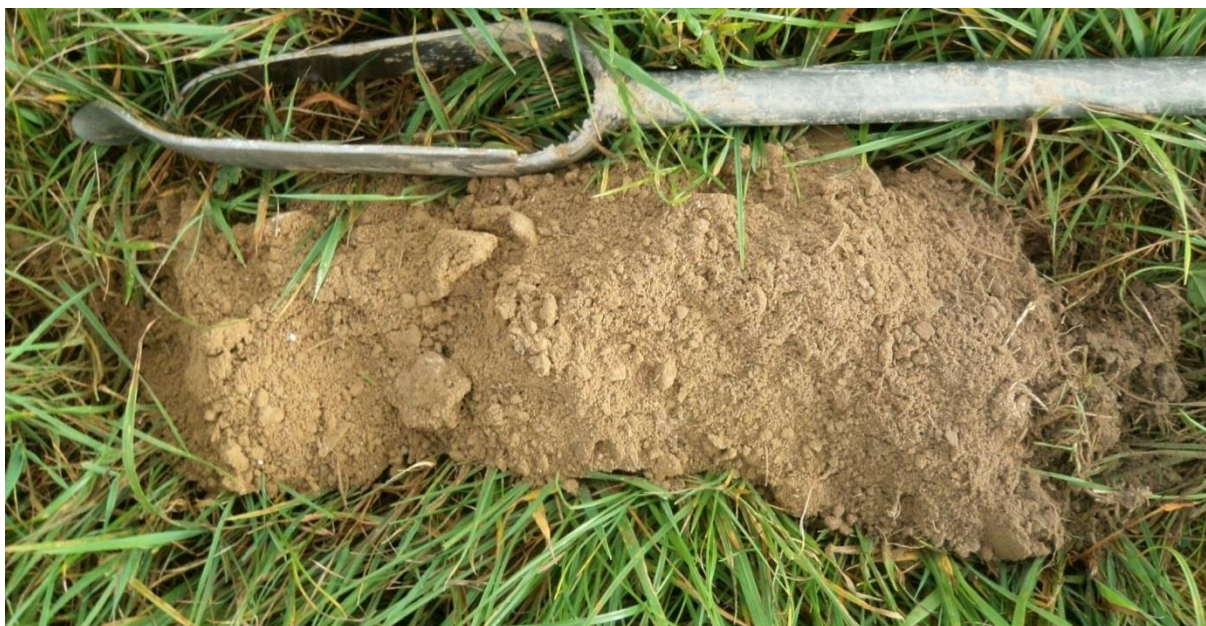
Sondage S2 montrant un limon à la couleur homogène (sol sain, sans trace d'hydromorphie)
