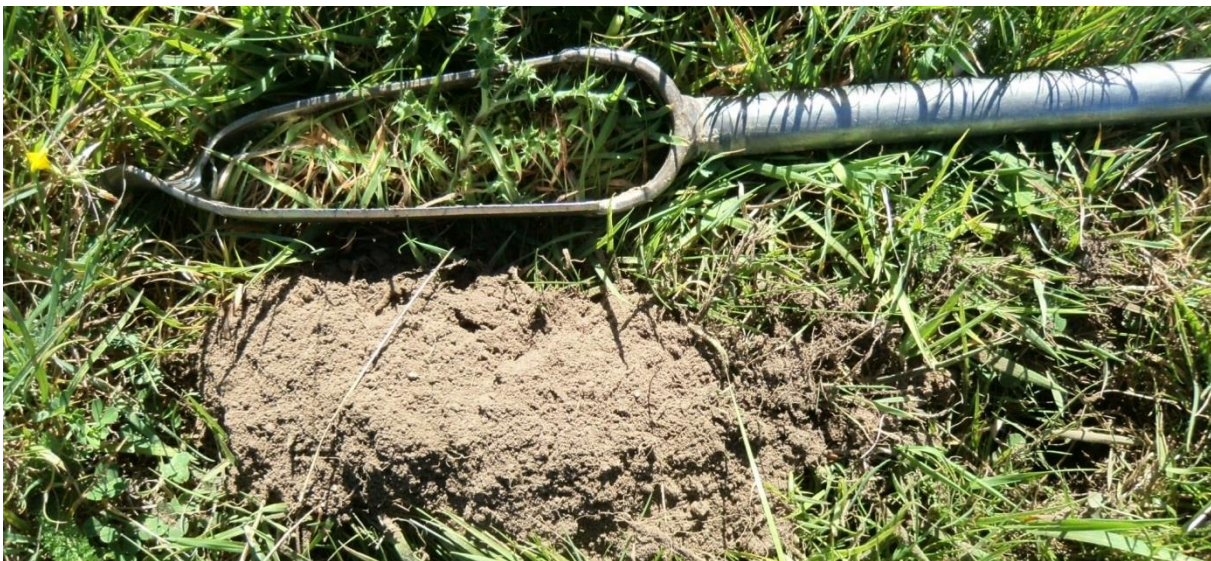
Sondage S73 montrant un limon peu profond et de couleur homogène : sol sain, sans trace d'hydromorphie
