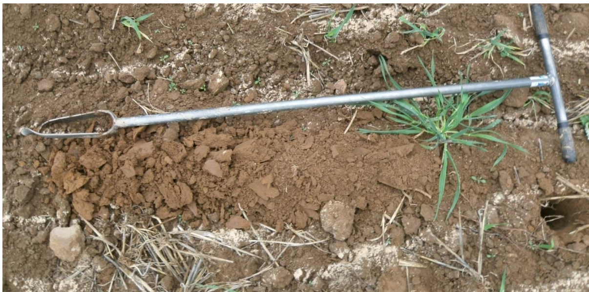
Sondage S3 montrant un limon profond et de couleur homogène : sol sain, sans trace d'hydromorphie
