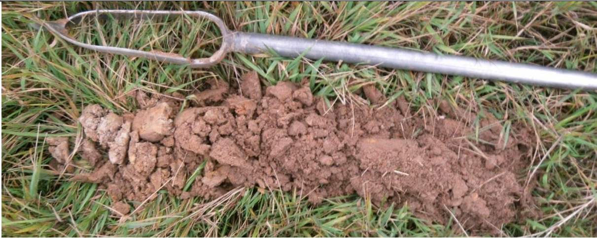
Sondage S200 montrant un limon sableux caillouteux peu à moyennement profond avec des traces d'hydromorphie marqués à partir de 30 cm de profondeur
