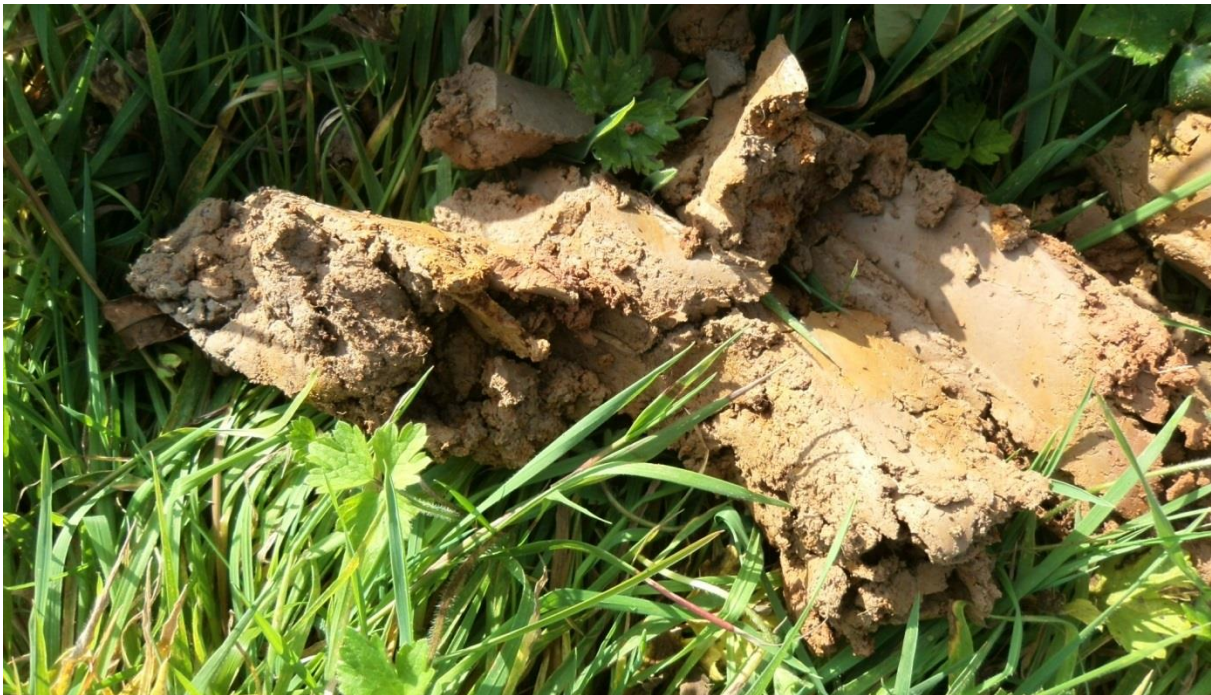
Sondage S174 présentant un limon bariolé gris / ocre entre 80 et 110 cm de profondeur
