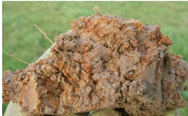
Détail des tâches ocres d'oxydo-réduction de sondage S188
