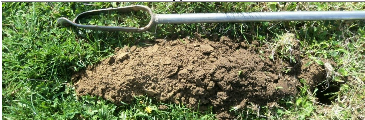
Sondage S135 montrant un limon moyennement profond et de couleur homogène : sol sain, sans trace d'hydromorphie
