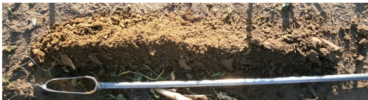
Sondage S120 montrant un limon profond et de couleur homogène. Quelques tâches ocre apparaissent en profondeur.
