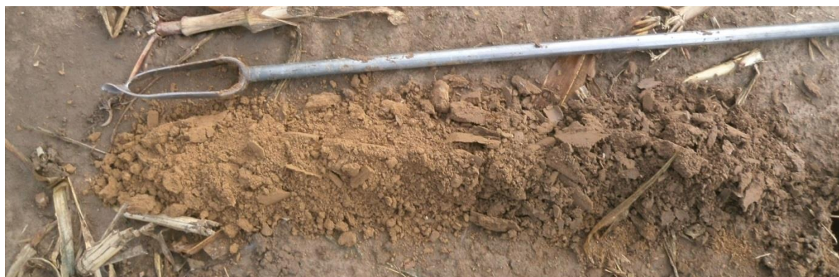
Sondage S147 montrant un limon profond et de couleur homogène
