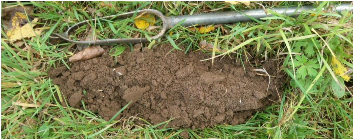
Sondage S159 montrant un limon sableux peu profond de couleur homogène : sol sain, sans trace d'hydromorphie
