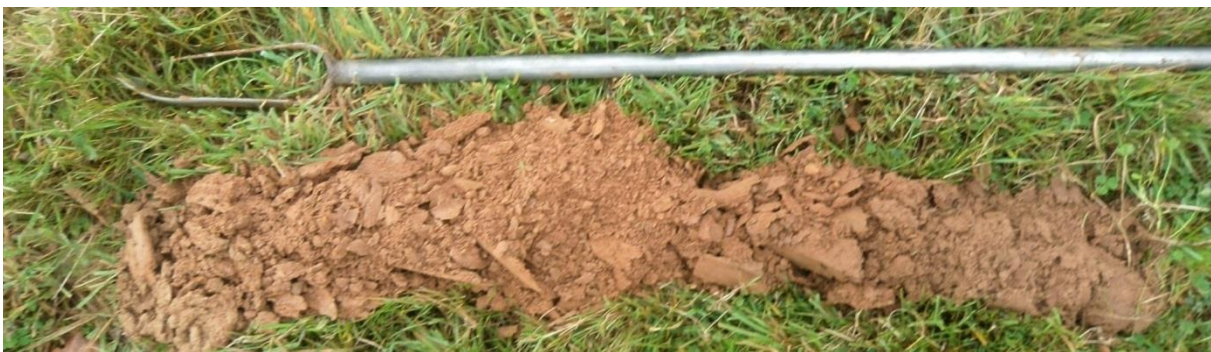
Sondage S170 montrant un limon profond, sain jusqu'à 60 cm de profondeur, puis présentant des traces d'hydromorphie
