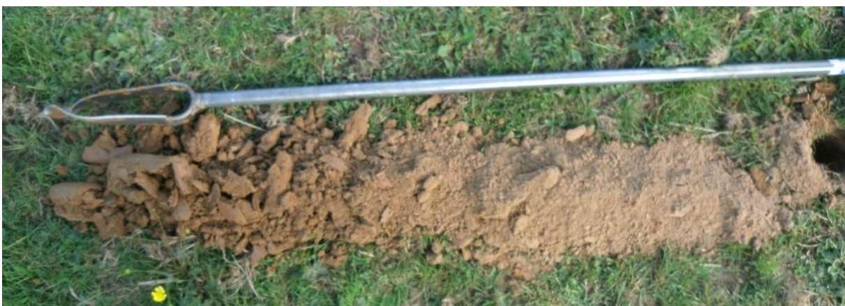
Sondage S22 montrant un limon profond et de couleur homogène : sol sain, sans trace d'hydromorphie
