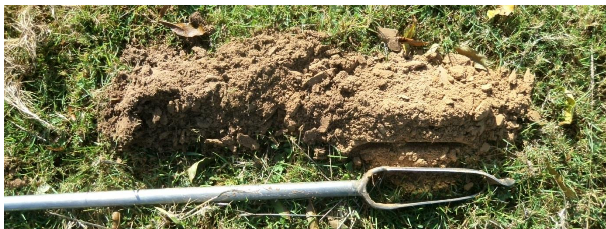
Sondage S126 montrant un limon profond et de couleur homogène : sol sain, sans trace d'hydromorphie
