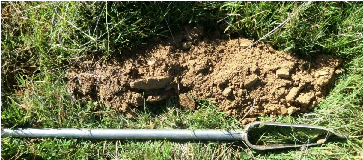
Sondage S79 montrant un limon moyennement profond et de couleur homogène bien qu'avec quelques tâches ocres
