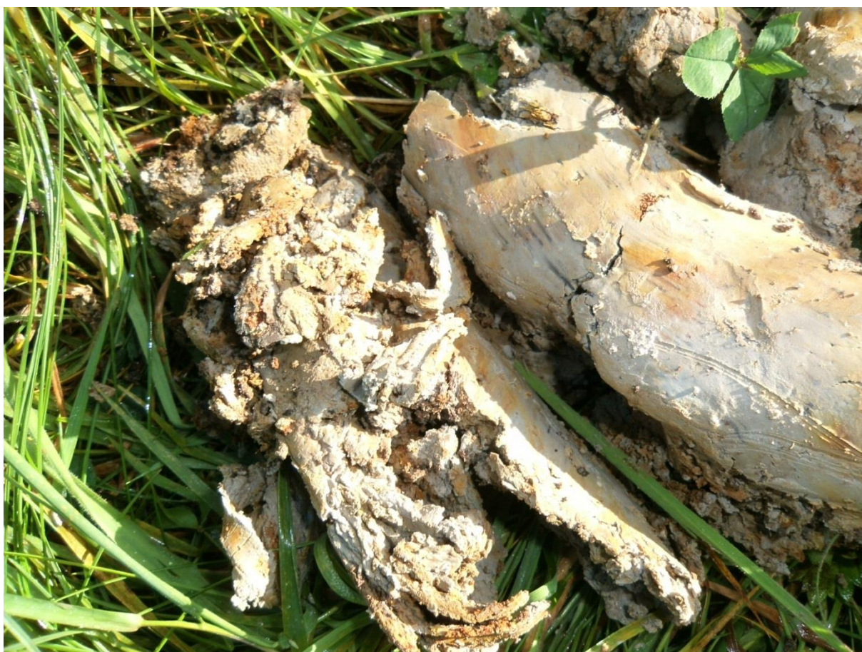
Bariolage ocre / gris observé en fond de sondage S52 : traits réductiques caractérisant un sol hydromorphe
