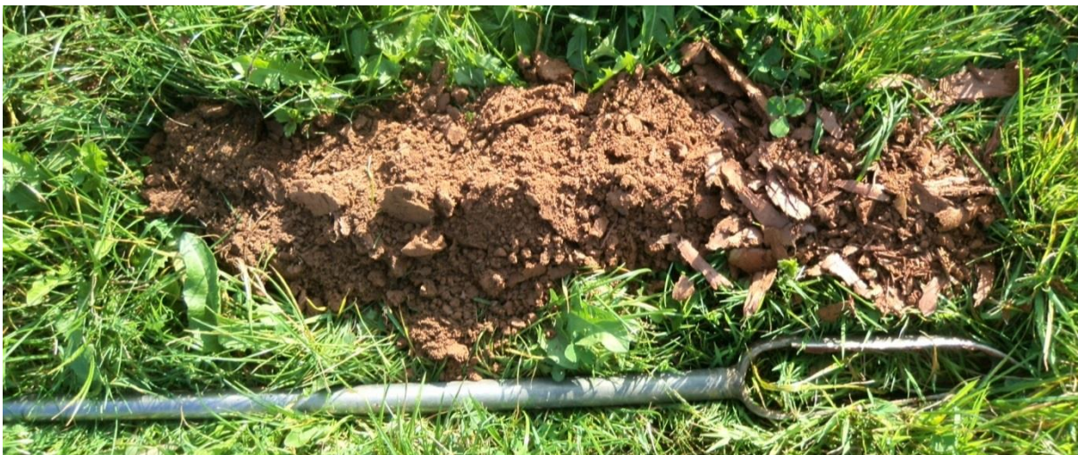
Sondage S167 montrant un limon moyennement profond, avec l'apparition d'un niveau argileux rougeâtre en profondeur, puis de cailloutis kaki
