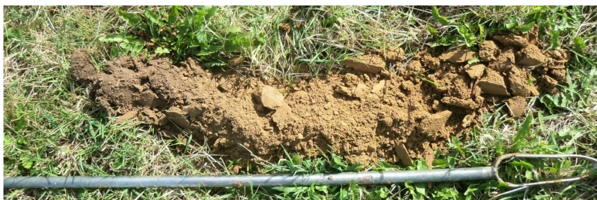
Sondage S136 montrant un limon profond et de couleur homogène : sol sain, sans trace d'hydromorphie
