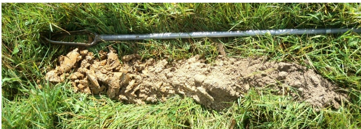
Sondage S63 montrant un limon profond, avec de nombreuses tâches ocre en profondeur (traces d'oxydation du fer)
