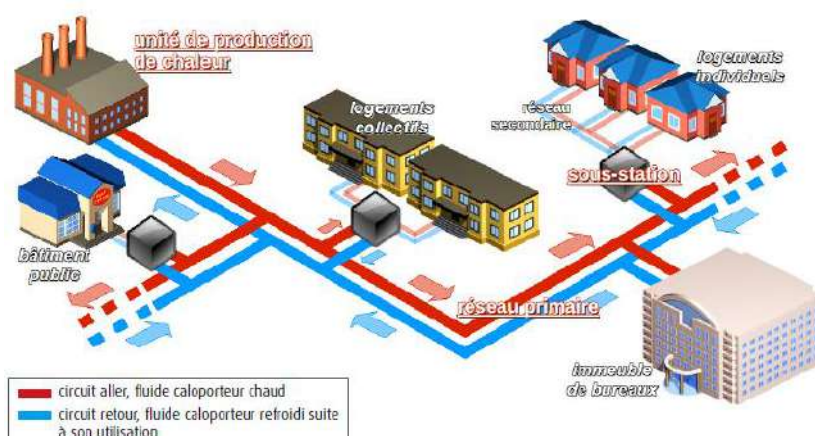
Schéma représentatif d'un réseau de chaleur – source : CEREMA Ouest – PCI réseaux de chaleur
