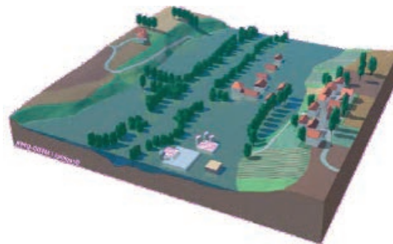
Lors de crues, le cours d'eau peut s'étendre plus ou moins largement dans le lit majeur et submerger les habitations et activités qui s'y sont installées.
