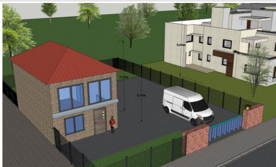
Exemple d'un bâtiment professionnel limité à 9 mètres au faitage (dans le cas présent 7,3 mètres)
