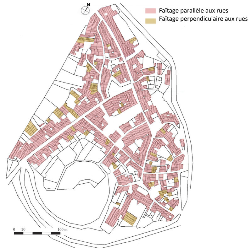
L'orientation des faîtages par rapport aux rues dans le bourg ancien
