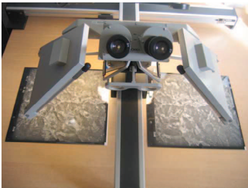
Figure 4 : stéréoscope à miroir monté sur chariot mobile en plan et couple d'images aériennes.
