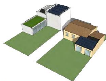
Panneaux implantés sur un pan entier de toiture
