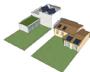
Panneaux implantés suivant les ouvertures et sur toiture terrasse la plus haute
