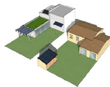
Panneaux implantés sur annexes, en brise-soleil
